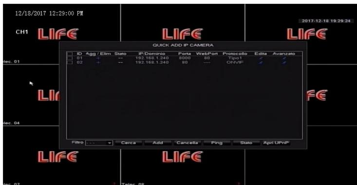
Cliccare su **[Cerca]** e poi sul **[+]** se la telecamera non viene aggiunta in automatico controllare le impostazioni e verificare i dati, in particolar modo utente e password. Attivare **[UPnP]** per associare le telecamere all'NVR tramite l'identificativo univoco MAC address.
