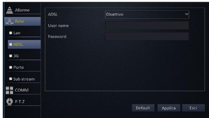
La funzione "ADSL" permette di configurare i parametri di collegamento PPPoE (Point-to-Point Protocol over Ethernet)
