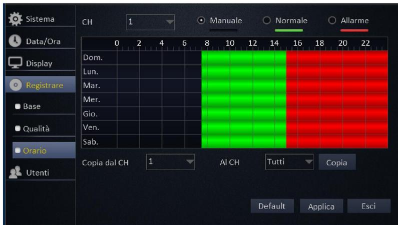
La funzione Orario permette di configurare per ogni telecamera una programmazione schedata Settimanale/24H.
