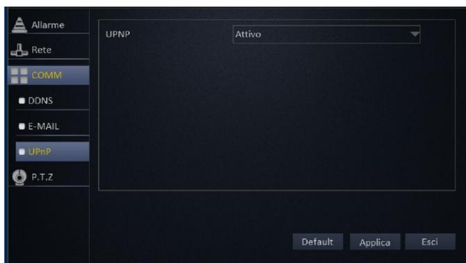
La funzione " UPnP ", (Universal Plug and Play) consente di configurare ed aprire automaticamente le porte di comunicazione necessarie al collegamento da remoto al DVR sul router.
