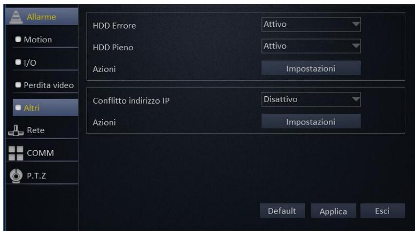
La funzione "Altri" permette di selezionare le azioni da eseguire in caso di HDD pieno/errore e conflitto indirizzi IP di rete.
