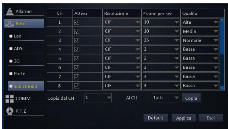
La funzione "Sub Stream" permette di configurare per ogni singola telecamera collegata la risoluzione, la fluidità e la qualità del flusso streaming secondario.
