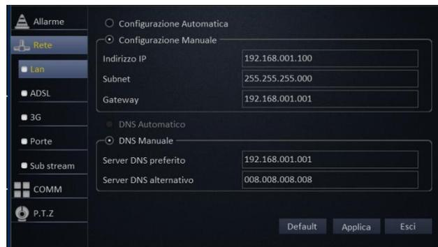
La funzione "LAN" permette di configurare i parametri di collegamento alla rete locale.
