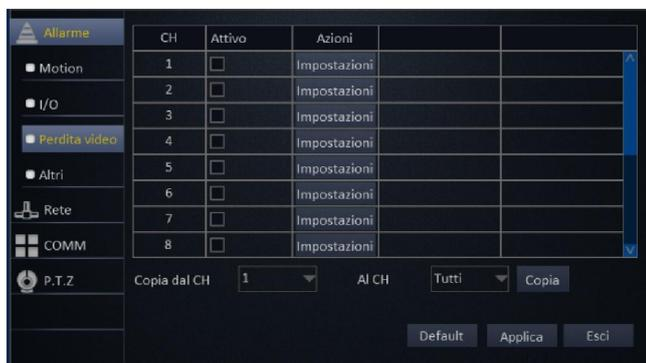
La funzione "Perdita video" permette di selezionare le azioni da eseguire in caso di assenza/perdita del segnale video in ingresso.
