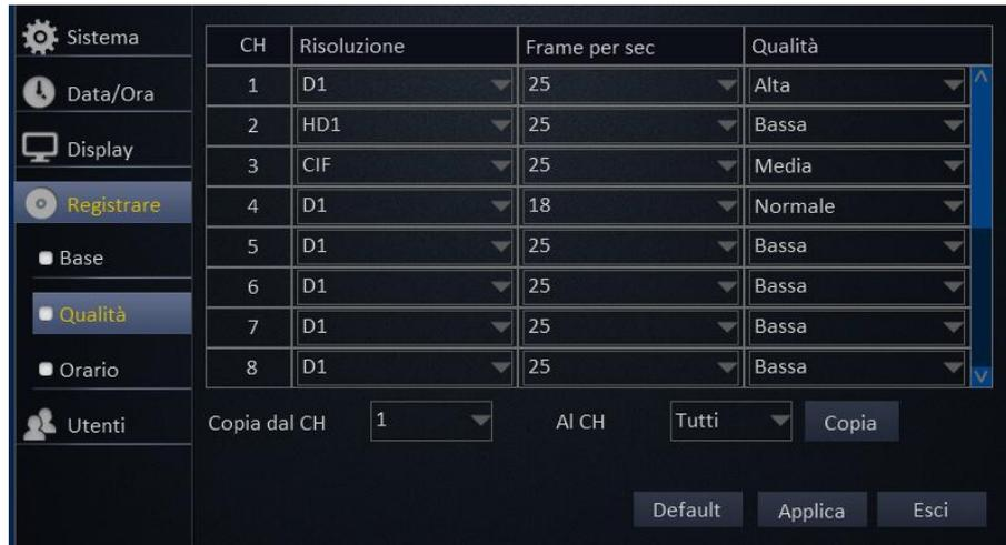
La funzione Qualità permette di configurare per ogni singola telecamera collegata risoluzione fluidità, e la qualità di registrazione.
