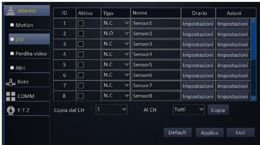
La funzione "I/O" permette di settare i contatti di ingresso/uscita collegati al DVR e le azioni da eseguire.
