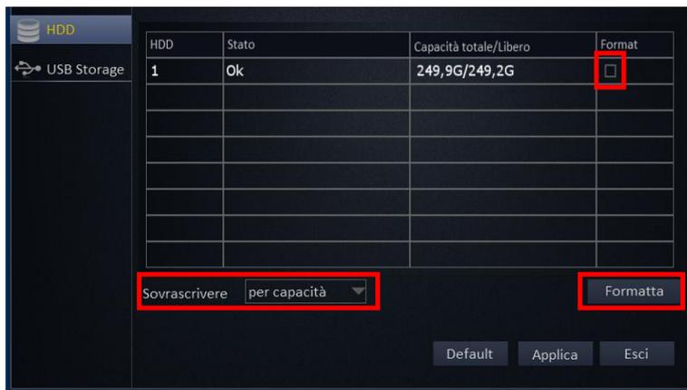
La funzione "HDD" permette di gestire la formattazione e la sovrascrittura degli HDD collegati al DVR. In tabella verranno visualizzate le informazioni relative allo stato e alla dimensione degli HDD montati.
