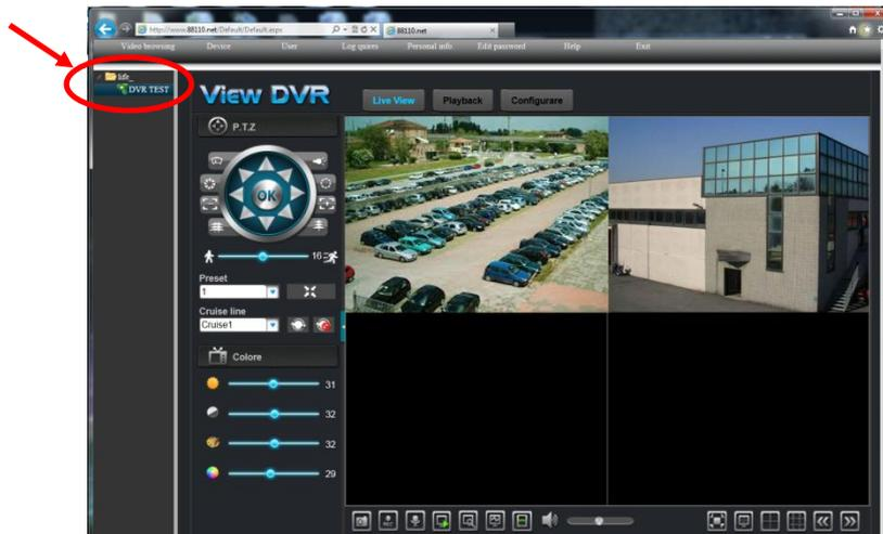
N.B Al primo accesso all'interfaccia web sarà necessario confermare l'installazione dei controller ActiveX di IE, necessari alla corretta visualizzazione delle immagini del DVR in rete.
