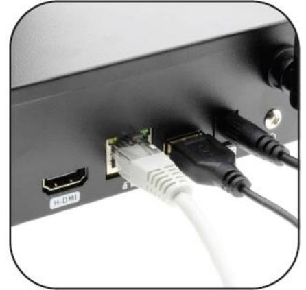
4. Se si vuole visualizzare l’impianto da remoto connettere un cavo di categoria Cat5e (LAN) per collegare l’NVR ad un router o modem per la connessione internet.
