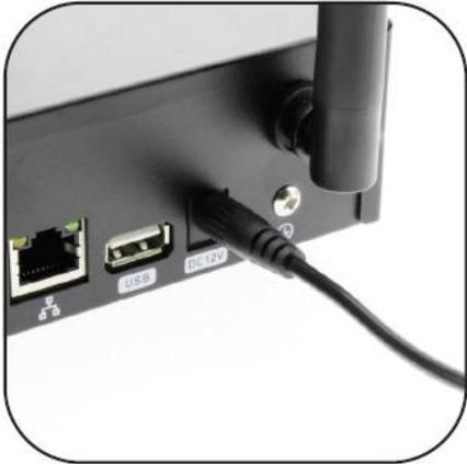
1. Per accendere l’NVR usare l’alimentatore in dotazione da collegare alla porta che si trova sul retro a tensione di DC12V.
