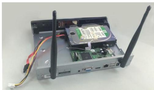
2. Collegare il cavo dati ed il cavo alimentazione dell'HD, avvitare le quattro viti per il bloccaggio.
