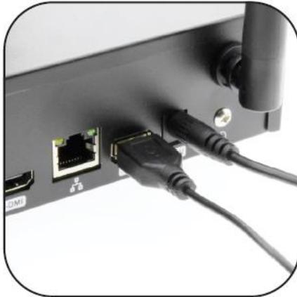
2. Connettere il mouse tramite la porta USB che si trova nella parte posteriore del NVR.
