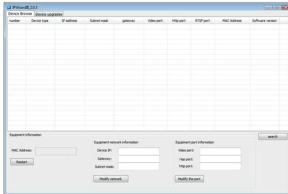
2. Fare clic sul pulsante SEARCH. Il programma inizierà a ricercare le telecamere IP presenti in rete. Attendere il completamento della ricerca. IPWIZARD è in grado di rilevare anche telecamere con classe di indirizzo diversa da quella del PC su cui si sta operando.
