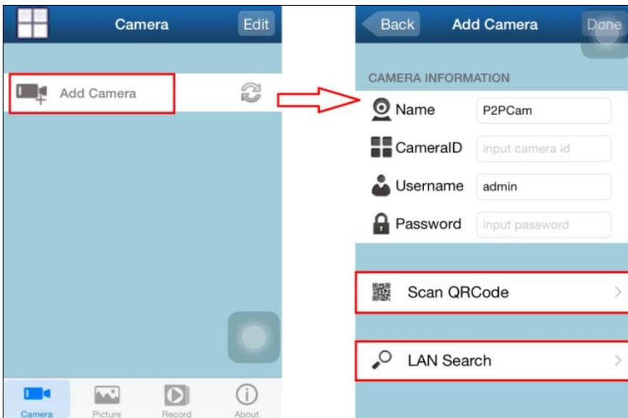
Una volta trovata la telecamera il campo CAMERA ID si riempirà automaticamente. E' possibile inserirne un nome della telecamera personalizzato ed occorre ovviamente completare le credenziali di accesso (di fabbrica admin/admin).
