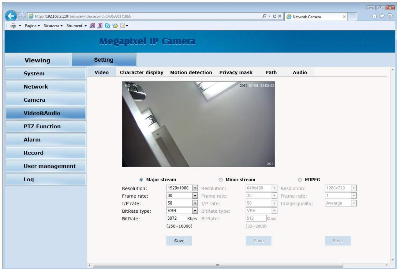
In questa sezione si imposta la caratteristica dello stream video della telecamera. La telecamera gestisce 3 stream: MAJOR STREAM (stream principale), SUB STREAM (stream secondario) e MJPEG STREAM (stream MJPEG con compressione statica). Dal client collegato è possibile definire quale stream utilizzare.
